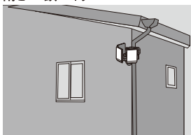
雨どい・鉄パイプ
